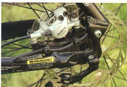
Zadní brzda, ač bez asistence Horst Linku a na spodním rameni, nebrání pérování v akci ani při ostrém stisku.
