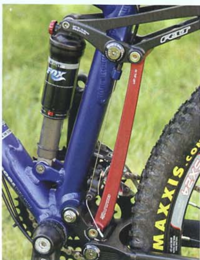
Červené táhlo Equalink vyrovnává pohyby dolního a horního ramene a tak neutralizuje vzájemnou pozici pohonu a odpružení.
