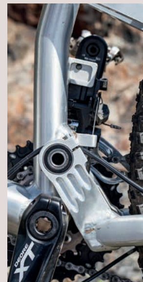
Velký průměr ložisek a frézované díly, to je u RB klasika
