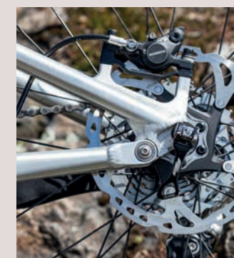
Pevná osa a Post Mount úchyt zadní brzdy jsou zde vyvedené s elegancí
